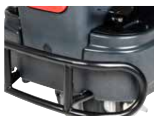
Zderzak przedni chroniący maszynę przed uszkodzeniami
