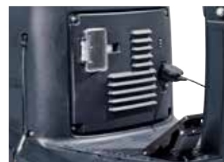
Zintegrowana ładowarka ułatwia podłączanie i ładowanie w każdym gniazdku
