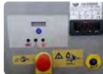
Quadro elettrico con termostato digitale Electrical box with digital thermostat
